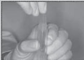
Immergere lo specchio per qualche secondo nell'apposita cuvetta dopo avergli messo una dose del liquido fornito ed una goccia del reagente.
