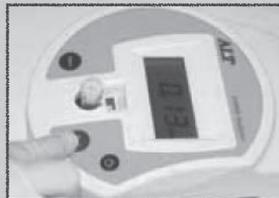
Mettere la cuvetta da nello spettrofotometro e seguire le semplici istruzioni fino ad ottenere il valore del campione.
